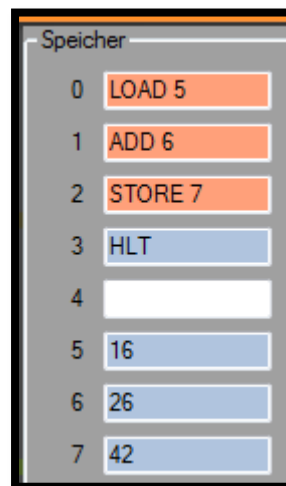
Abbildung 10 – Mehrere Befehle werden vom Befehlssatz "Minimal" nicht unterstützt
